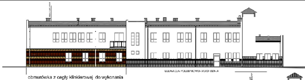
obmurówka z cegły klinkierowej do wykonania
