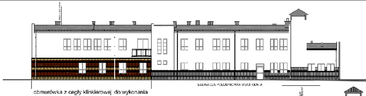
obmurówka z cegły klinkierowej do wykonania
