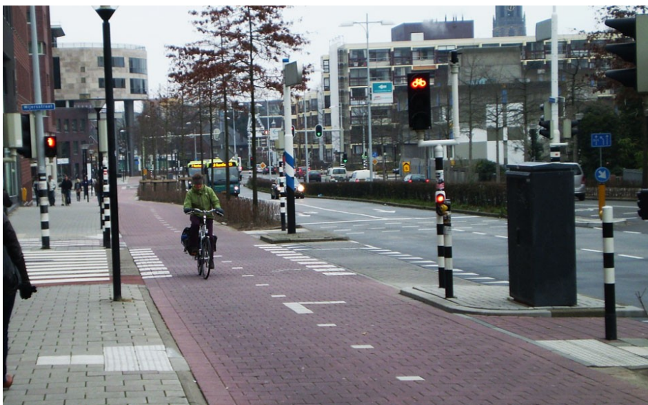
Fotografia 42. Warszawa, ul. Podleśna – prawidłowe rozmieszczenie i oznakowanie słupków przeciw wjeżdżaniu samochodów – słupek zawsze powinien być umieszczony pośrodku szerokości ścieżki rowerowej, aby umożliwić minięcie się rowerzystów nadjeżdżających z przeciwnych stron
