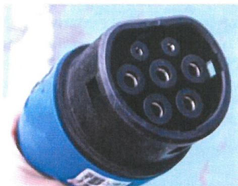
Rysunek 2 Graficzny zarys wtyczki typu 2 3
