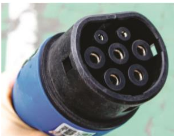
Rysunek 34 Graficzny zarys wtyczki typu 2
