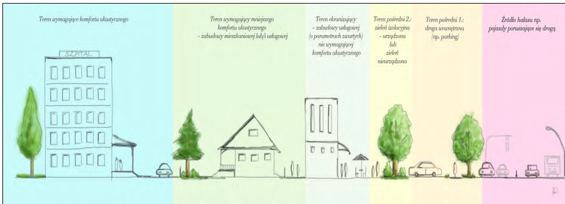
Rys. 10.1. Zasady strefowania zabudowy względem źródła hałasu drogowego
