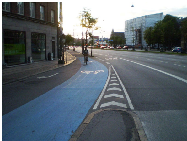
Fotografia 20. Przykład przeprowadzenia ruchu rowerowego przez skrzyżowanie pasami dla rowerów (Kopenhaga)
