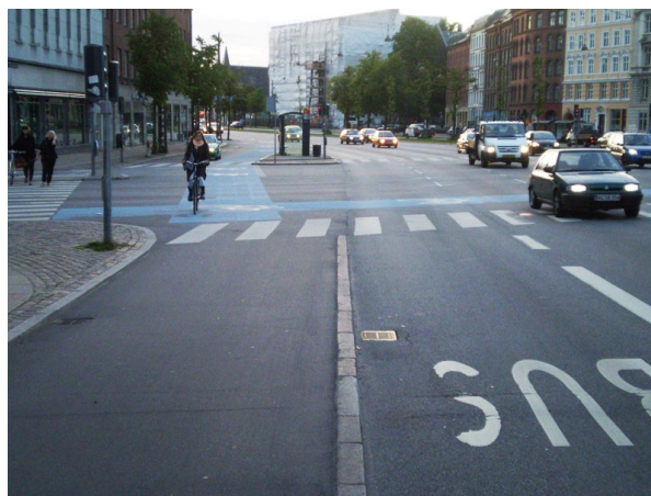
Fotografia 20. Przykład przeprowadzenia ruchu rowerowego przez skrzyżowanie pasami dla rowerów (Kopenhaga)
