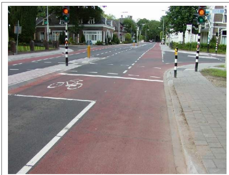
Fotografia 8. Pas dla rowerów ze służą rowerową przed skrzyżowaniem (De Steeg, Holandia)
