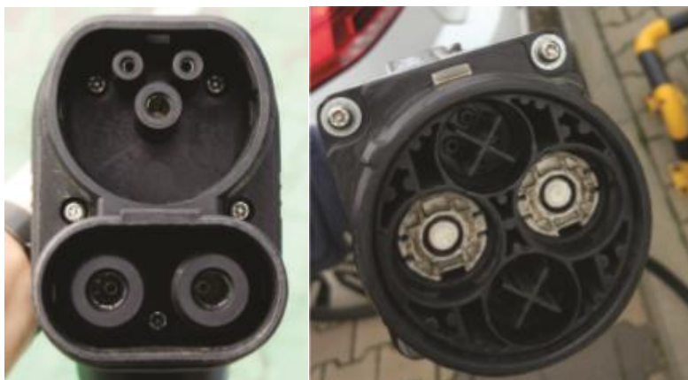
Rysunek 35 Graficzny zarys wtyczek: po lewej typ 2 COMBO (CCS) oraz po prawej typ CHAdeMO
